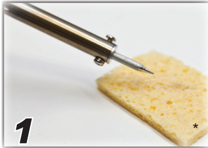
1 Wipe tip - Reinig de punt - Nettoyez la panne - Reinigen Sie die Spitze - Limpie la punta
